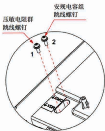
图 6-2 压敏电阻（VDR）、安规电容（EMC）对地跳线位置示意图
