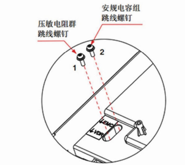
图 1-4 压敏电阻（VDR）、安规电容（EMC）对地跳线位置示意图
