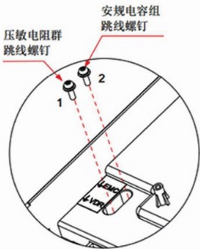
图 1-4 压敏电阻（VDR）、安规电容（EMC）对地跳线位置示意图
